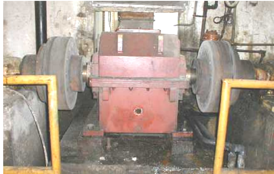
Reduktor sa dva izlazna vratila
